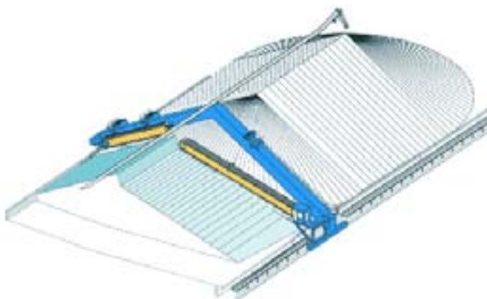
Almacenamiento longitudinal con sistema de recuperación de pórtico con pluma doble
