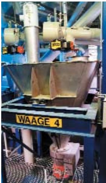
Sistema de Mistura para operação por batelada
