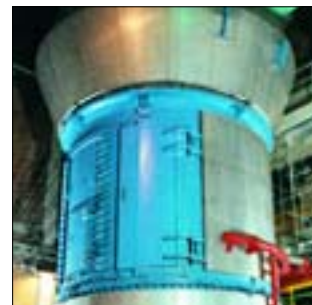
Bis 3,5 bar druckstoßfestes Gehäuse. Große Mühltüren für einfaches Wechseln der Mahlelemente
