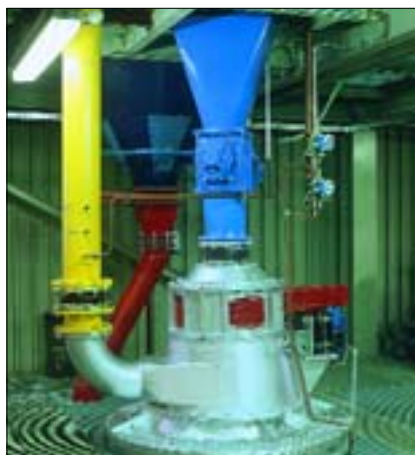
Versuchsmahlanlage mit dynamischem Sichter im Claudius Peters Technikum
