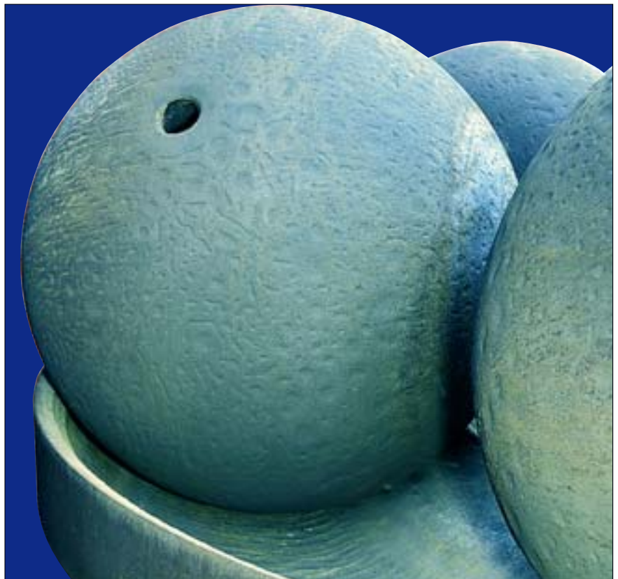
Mahlelemente nach 25.000 wartungsfreien Betriebsstunden
