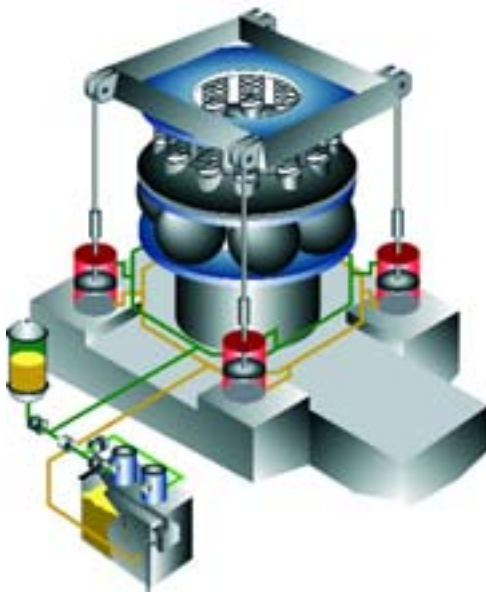
Selbstjustierende Hydraulik nach dem Federbeinprinzip: Druck- und Verschleißoptimierung bei geringem Energiebedarf
