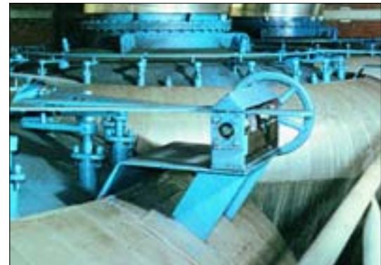
Statische oder dynamische Sichter lassen sich exakt auf die gewünschte Feinheit des Produktes einstellen
