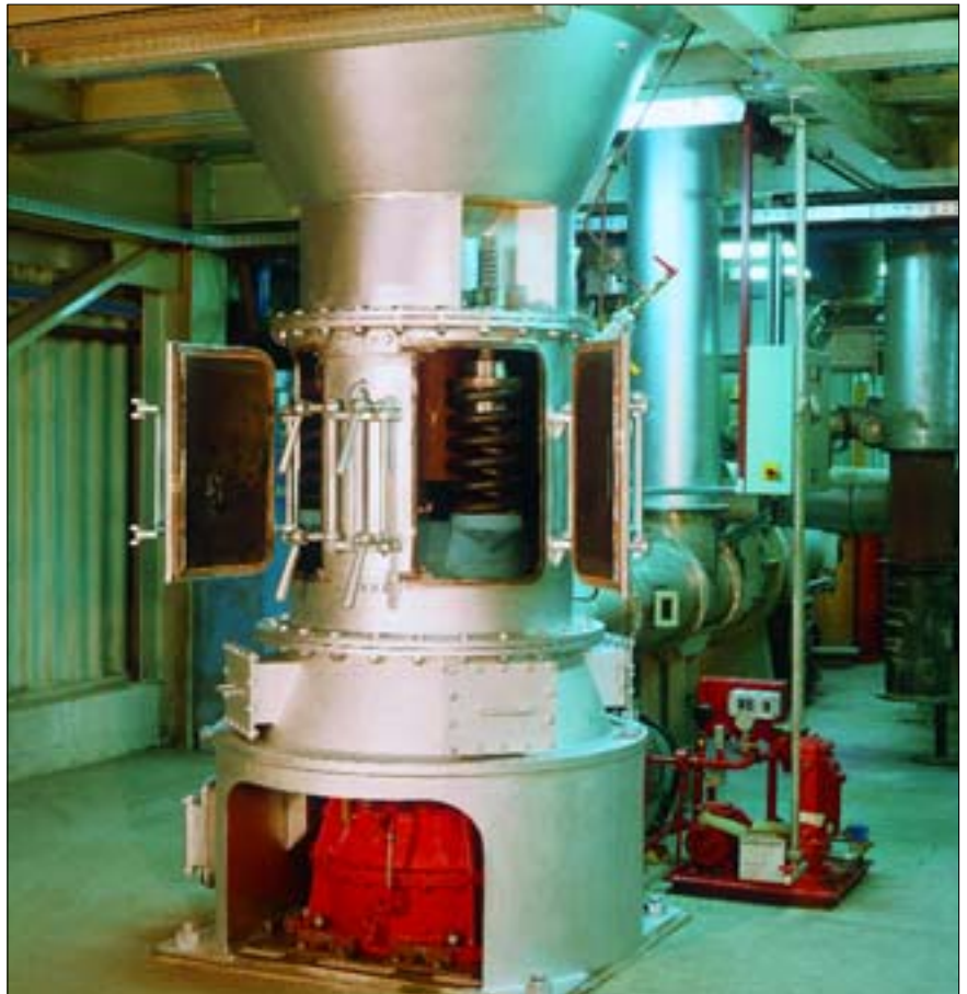
Versuchsmahlanlage mit dynamischem Sichter im Claudius Peters Technikum
