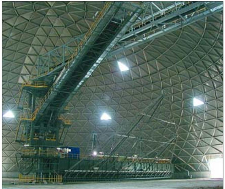
oder horizontal ab. Die Abzugleistung wird über die Eindringtiefe des Kratzers in das Materialbett sowie die Geschwindigkeit der Abzugsvorrichtung justiert. Ausrüstungen dieses Typs decken Leistungsbereiche von 50 t pro Stunde bis zu mehr als 1500 t pro Stunde für große Lagerplatzkapazitäten ab.
