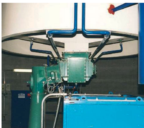
Austragstunnel unter dem Silokonus sorgt für konstante Austragsbedingungen am Auslauf
