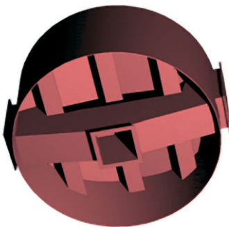
Austragstunnel unter dem Silokonus sorgt für konstante Austragsbedingungen am Auslauf
