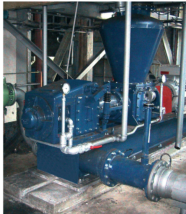
Höchste Flexibilität bei der Auslegung der Austragsseite (Beispiel: linksseitiger Auslauf)
