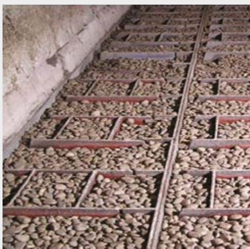
Cama de grava con carril de aireación.
