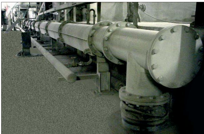
Sistema de transporte FLUIDCON, en la planta de la firma Holcim en Lägerdorf para 230 t/h de cemento.
