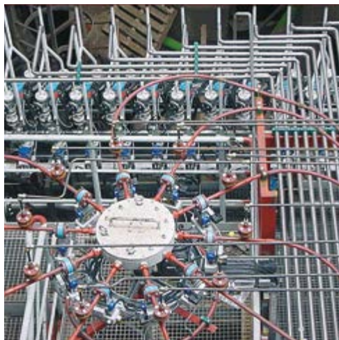
Distribuidor de carbón.
