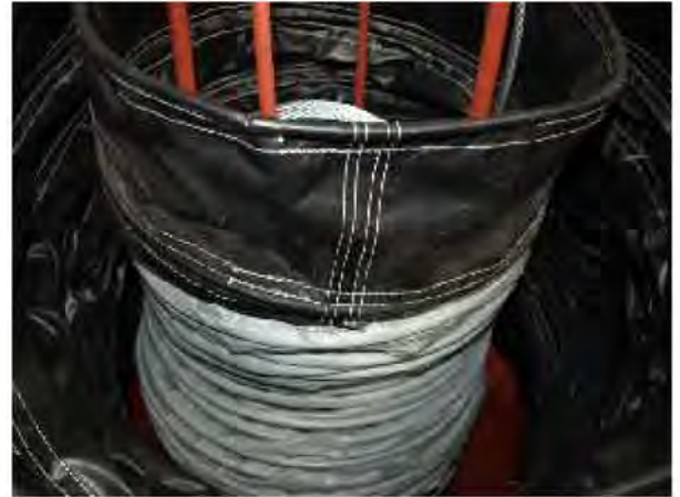
وسیله بارگیری با فانوسه های خارجی و داخلی جهت مواد متعارف ( نظیر سیمان)
