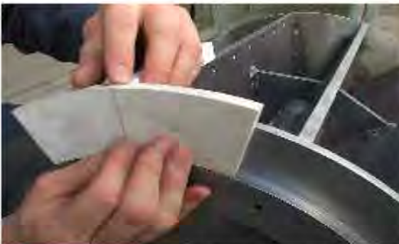
سلول گردانه نصب شده دارای اجزاء مستهلک شونده سرامیکی
