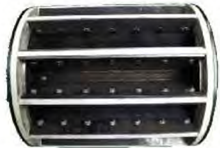
سلول گردانه نصب شده با اجزاء سایشی
