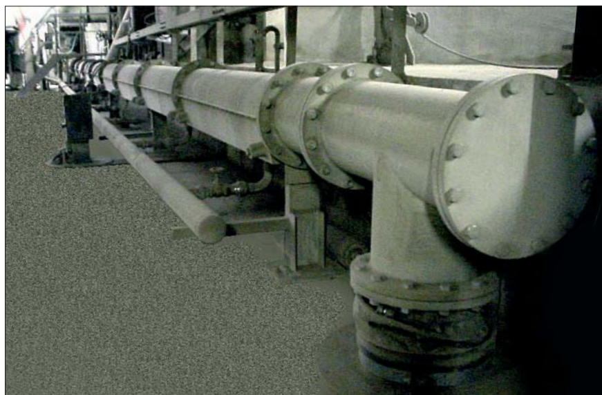
Système de transport FLUIDCON de 230 t/h de ciment à l'usine Holcim de Lägerdorf
