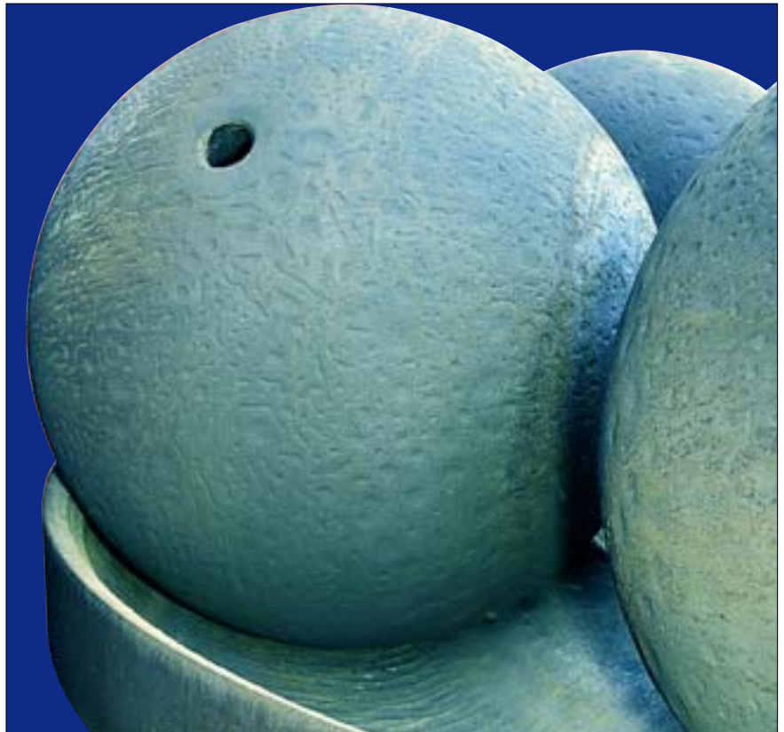
Eléments de broyage après 25 000 heures de fonctionnement sans entretien.
