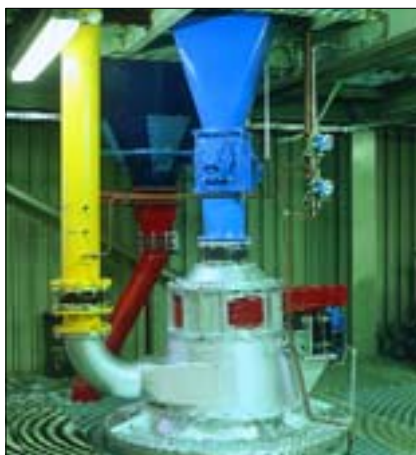
Broyeur équipé d'un séparateur dynamique pour tests dans le centre d'essais de Claudius Peters
