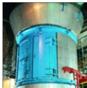
Casing résistant aux explosions jusqu'à 3,5 bars. Grandes portes de visite facilitant le remplacement des éléments de broyage.
