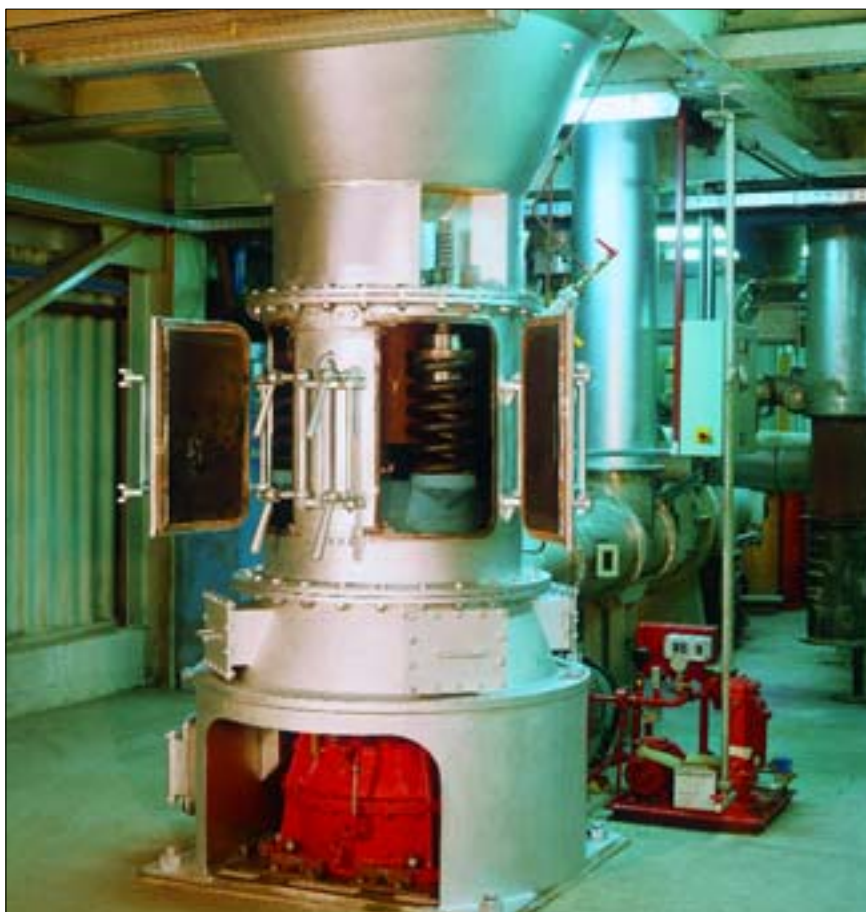
Broyeur équipé d'un séparateur dynamique pour tests dans le centre d'essais de Claudius Peters
