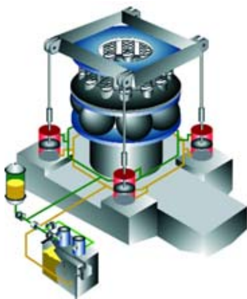
Système hydraulique autorégulé absorbant les chocs. Optimisation de l'usure et de la pression pour une plus faible consommation d'énergie.
