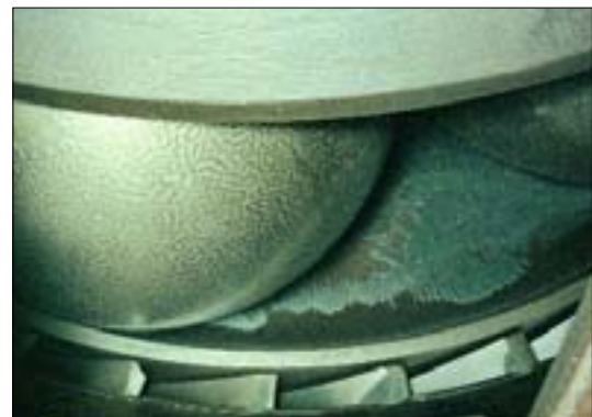
Mécanisme de broyage autonettoyant pour éviter tout risque d'accumulation de charbon.
