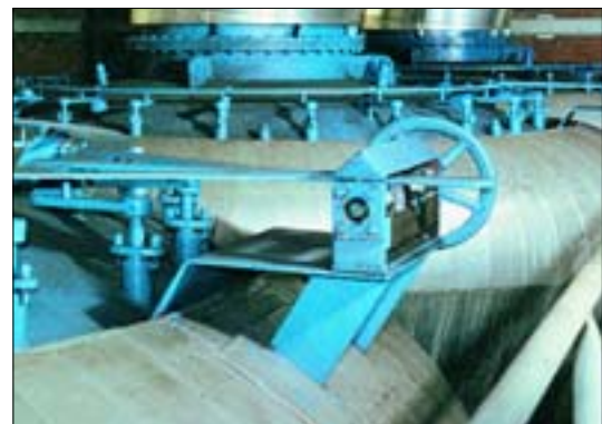
Les séparateurs statiques ou dynamiques peuvent être ajustés pour obtenir avec exactitude la finesse désirée.
