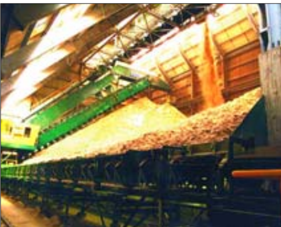
Gratteur semi-portique pour bagasse (biomasse)
