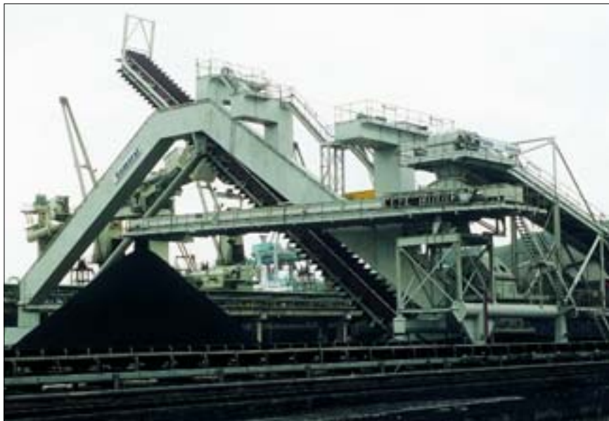
Stacker/gratteur combiné pour terminal charbon
