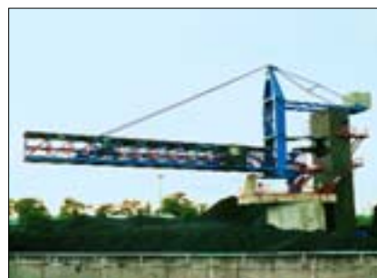
Stacker charbon en centrale thermique
