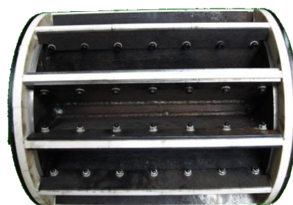
Rotor avec revêtement céramique anti-usure
