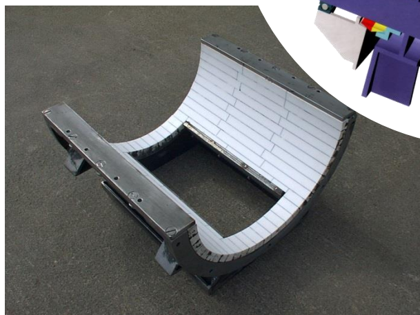
Revêtement avec plaques de céramique
