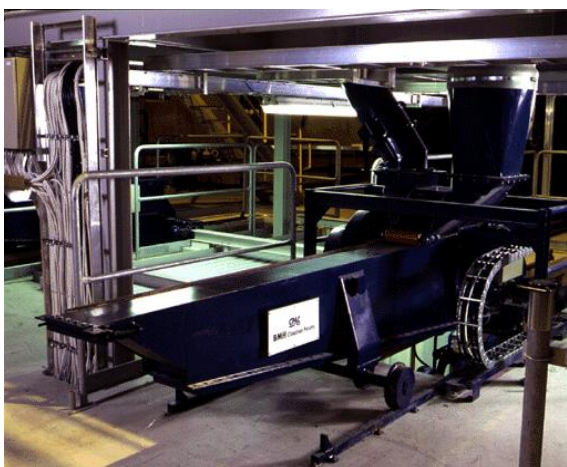
Chargeur mobile avec courses de translation entre 1 et 15 m
