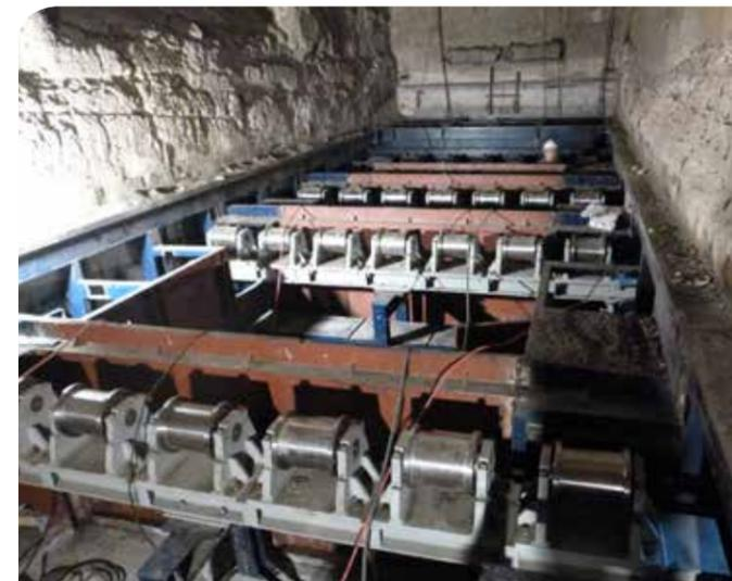
Figura 4. Raffreddatore pronto all'installazione delle corsie
