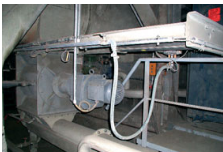
Sistema de transporte FLUIDCON na planta Lägerdorf da Holcim, para 230 t/h de cimento
