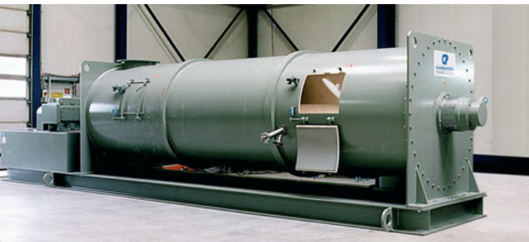
Sistema de mistura para operação contínua
