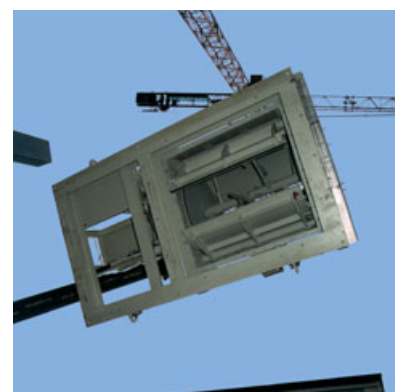
Conjunto de um misturador por batelada com sistema de descarga por duplo flap
