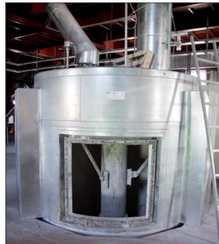
Рис. 5. Гомогенизатор на предприятии GIPS AD (Видин, Болгария), производительность 14 т/ч
