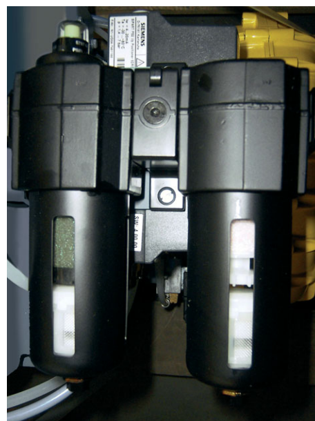
Профилактическое техническое обслуживание с помощью блока кондиционирования воздуха
