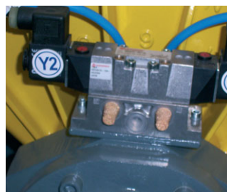
Электромагнитные клапана для регулировки промежуточных положений
