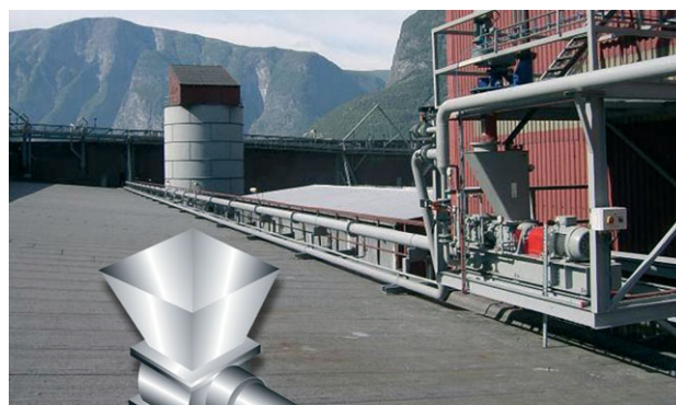
Питание пневмовинтового насоса типа X посредством разгрузочного оборудования Claudius Peters
