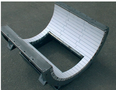
Футеровочные керамические пластины втулки
