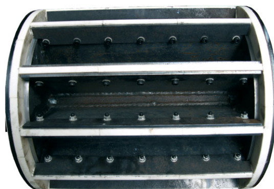
Собранная ячейка ротора с керамическими элементами
