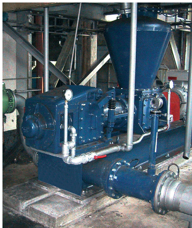
Высокая гибкость в направлениях разгрузки материала из пневмовинтового насоса (например, левосторонний выход)
