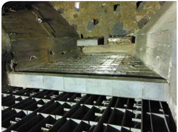
图5 - 固定进料端与列向单元之间的过渡部位
