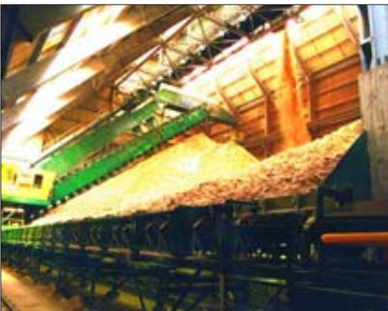
Semiportalkratzer für Bagasse (Biobrennstoff)
