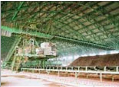
Kalksteinabsetzer in einem Zementwerk
