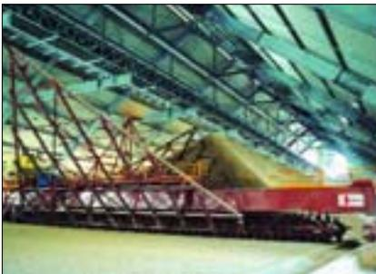
Brückenkratzer für Kalkstein (Zementwerk)
