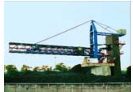
Kohleabsetzer in einem Kraftwerk
