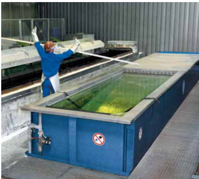
Herausheben aus dem Salzbad und Abschrecken im Abschreckbad
