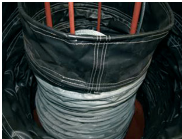
Manche de chargement souple sur l'intérieur et l'extérieur, pour matériaux standard (ex: ciment)
